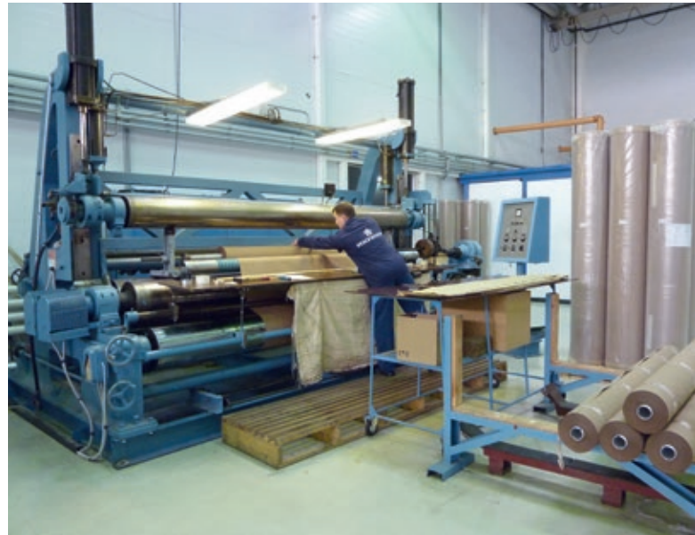
Рис. 12. Намотка бумажной изоляции 110 кВ широким полотном на заводе «Изолятор»
