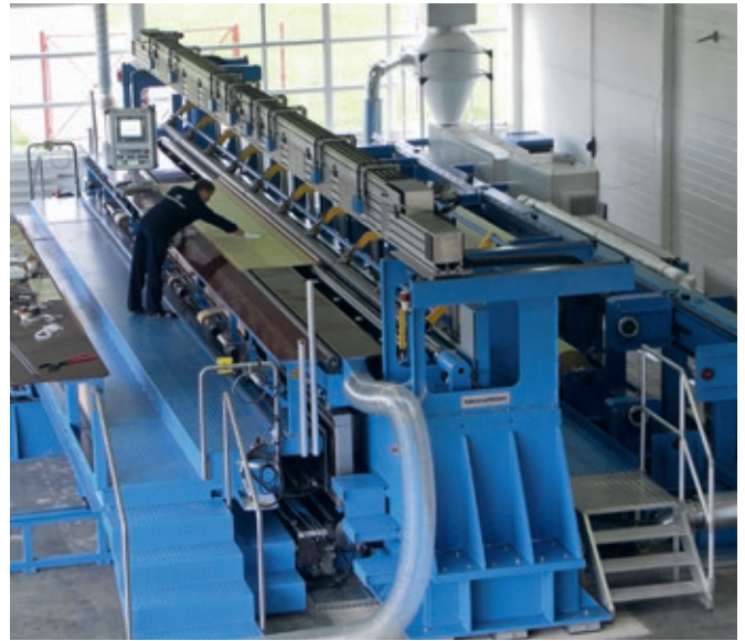
Изготовление основной изоляции вводов на заводе «Изолятор»
