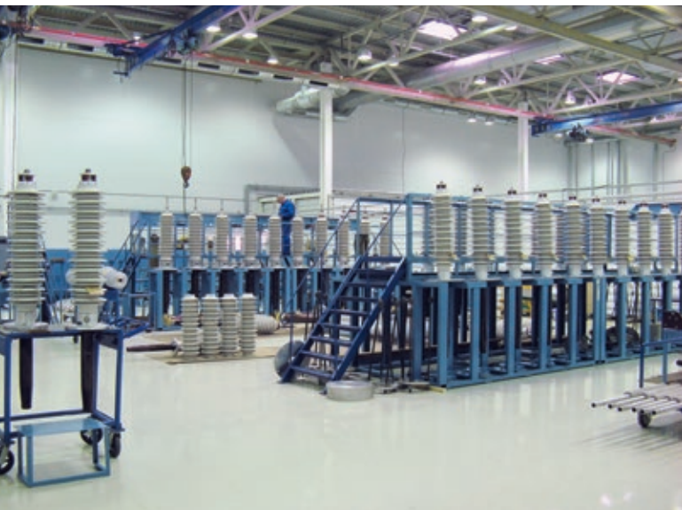
Рис.15. Сборка вводов 110 кВ с фарфоровой внешней изоляцией на заводе «Изолятор»
