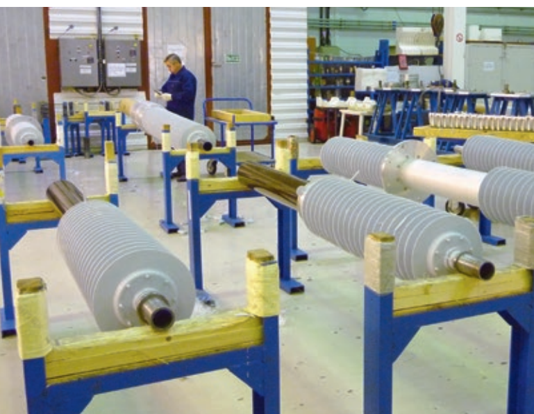
Рис. 17. Подготовка к контролю качества полимерной изоляции на заводе «Изолятор»
