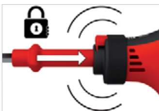
Автоматическая / механическая фиксация жал
