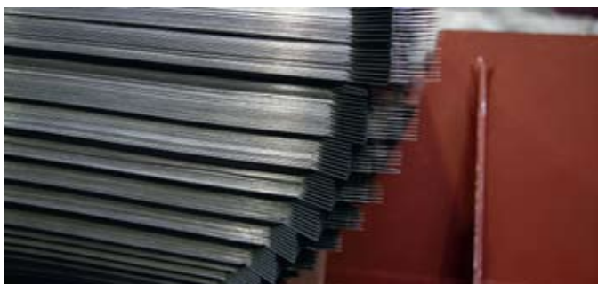
Сборка и шихтовка магнитопровода по технологии Step-lap
