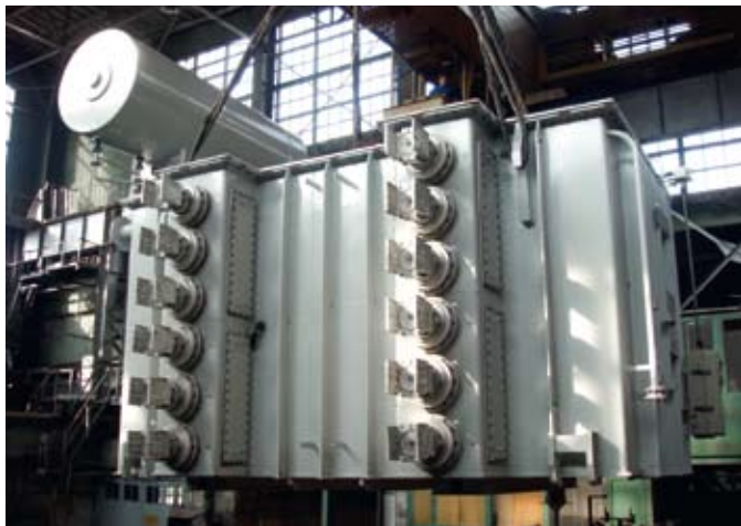
Трансформатор ТАДЦНПФ-40000/10 УХЛ1 для электролиза никеля
