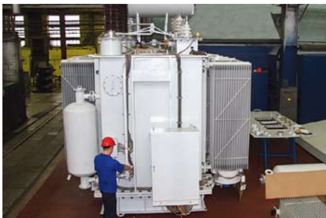
Контрольная сборка трансформатора ТДТН-25000/110 Т1 для поставки на Кубу
