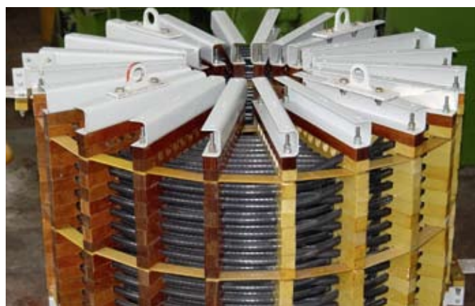
Токоограничивающий реактор РТСТ 10-1000-0,56 УЗ
