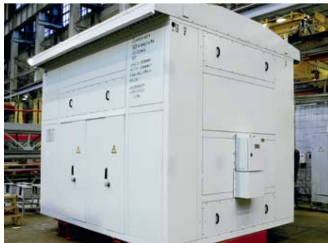
Трансформатор ТСЗ-6300/35 М1
