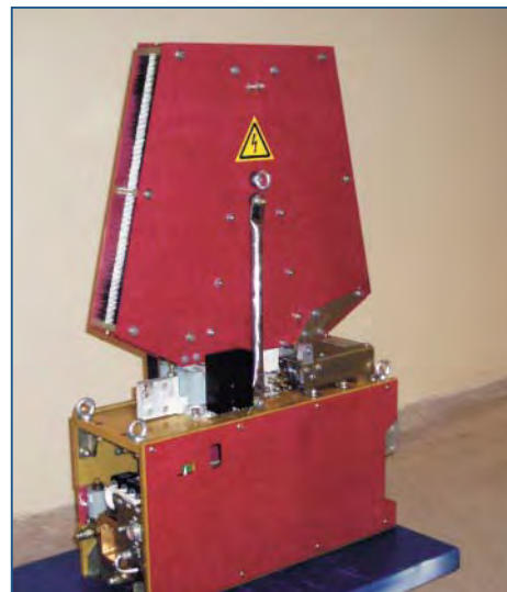
Выключатель типа ВАБ-55 для электровозов
