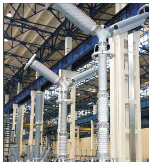
Элегазовые выключатели ВГК-500, ВГГ-330
