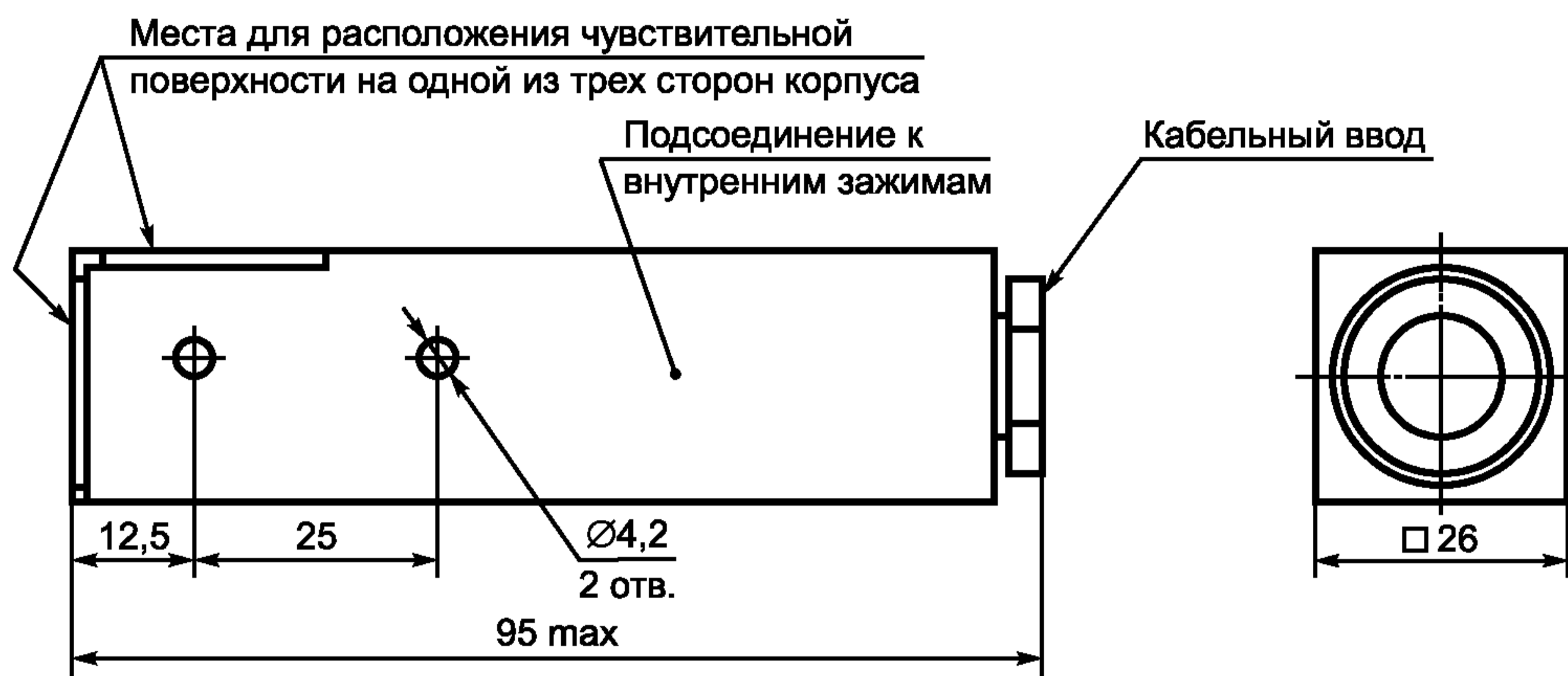
Рисунок А.1 (IC) — Габаритные размеры
