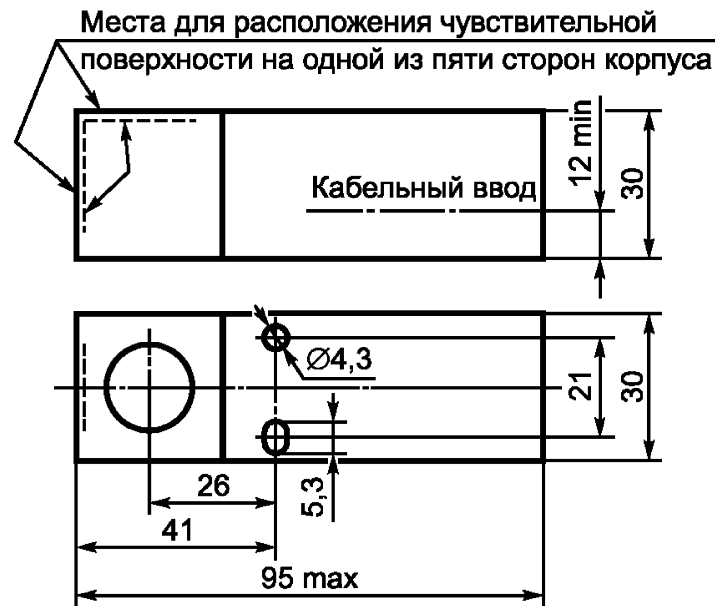
Рисунок А.1.3 (IC) — Габаритные размеры
