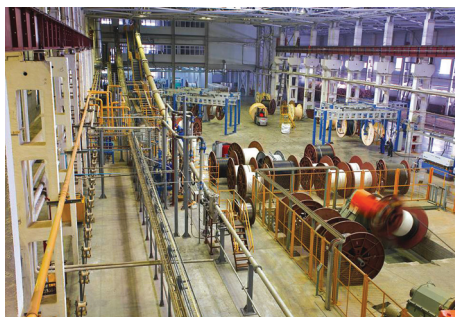
Линии изолирования EPL 30 (6–35 кВ) и EPL 50 (6–220 кВ) Maillefer
