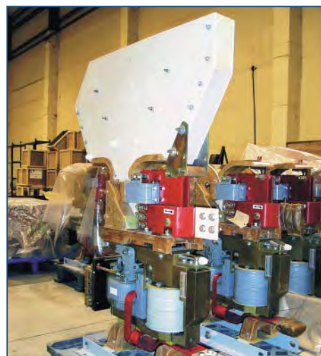
Выключатель типа ВАТ-43 для тяговых подстанций городского электротранспорта
