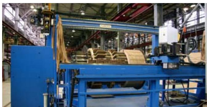
Изготовление обмоток ведется на намоточных
