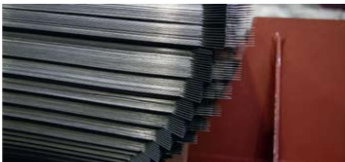
Сборка и шихтовка магнитопровода
