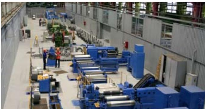
Линия резки электротехнической стали
