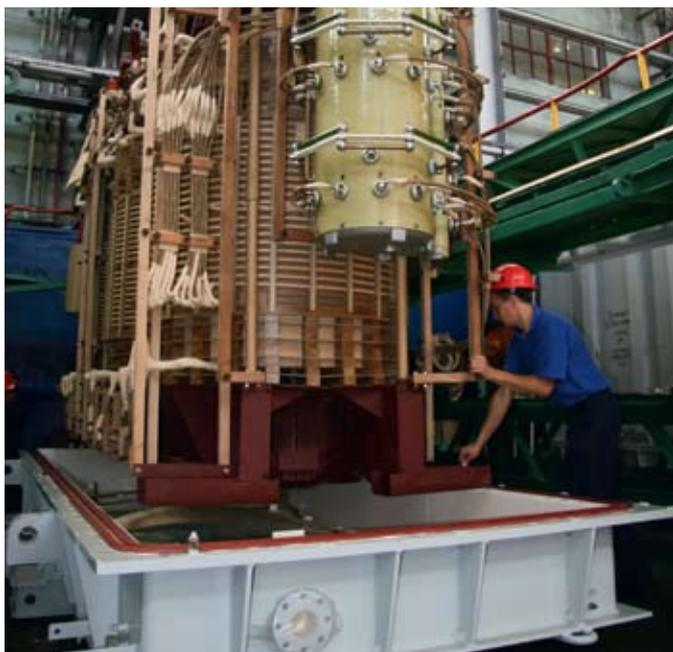
Установка активной части трансформатора в бак
