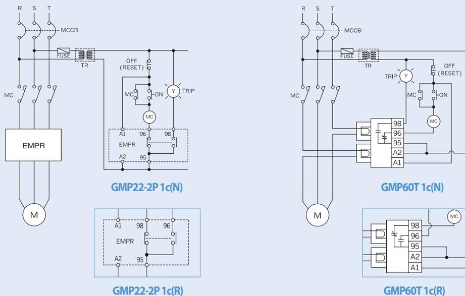
Примечание) Тип 1c(N): отказозащищенный тип контакта (размыкается при исчезновении, замыкается при подаче 1c(R) напряжения). Тип 1c(R): отказозащищенный тип контакта.
