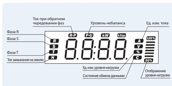
Примечание) Индикаторы kW, kVar и V будут использоваться в разрабатываемых моделях с защитой под напряжением.
