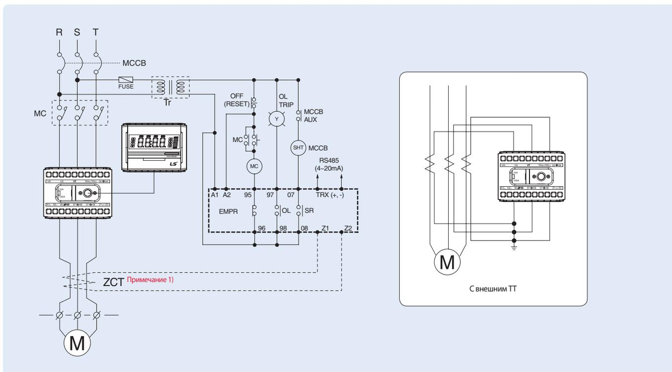
Примечание) 1. Если для обнаружения замыкания на землю используется трансформатор тока нулевой последовательности, то подключите ZCT.
