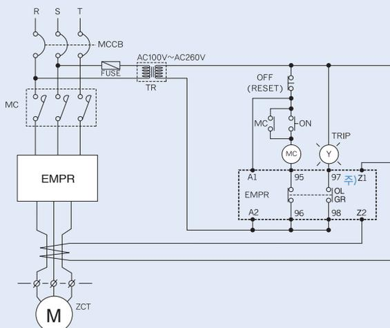
Примечание) 1. Выводы Z1, Z2 – входы для подключения ZCT (реле типа GPM60-3TZ/TZ)
