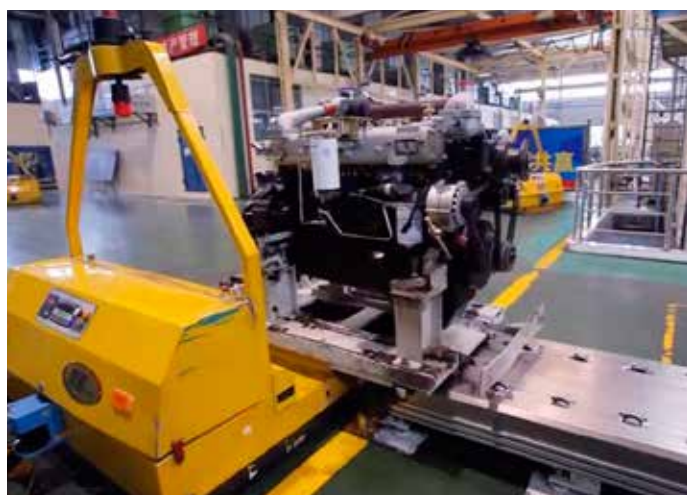
Транспортер на воздушной подушке
