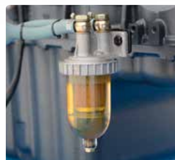
Топливный фильтр - влагоотделитель
