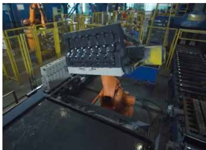
Автоматическая покраска блока двигателя
