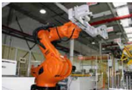
Робот «KUKA» для нанесения герметика
