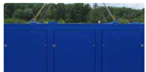
Отверстия для строповки
