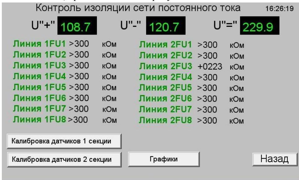
Рисунок 10. Снижение сопротивления изоляции на линии.
