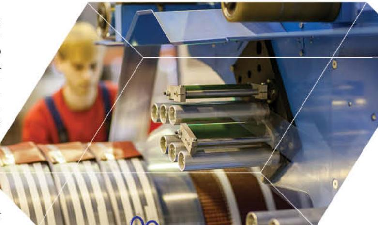
Для изготовления магнитопроводов используется высококачественная электротехническая сталь с низким уровнем потерь как отечественных, так и лучших зарубежных производителей.
