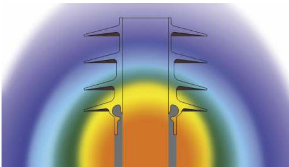
Улучшенное распределение электрического поля в заделке по сравнению с традиционной схемой.
