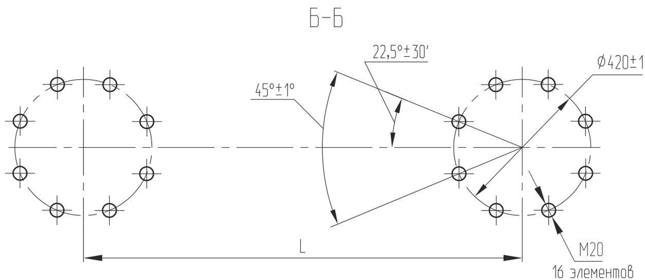
Расположение отверстий контактного вывода
