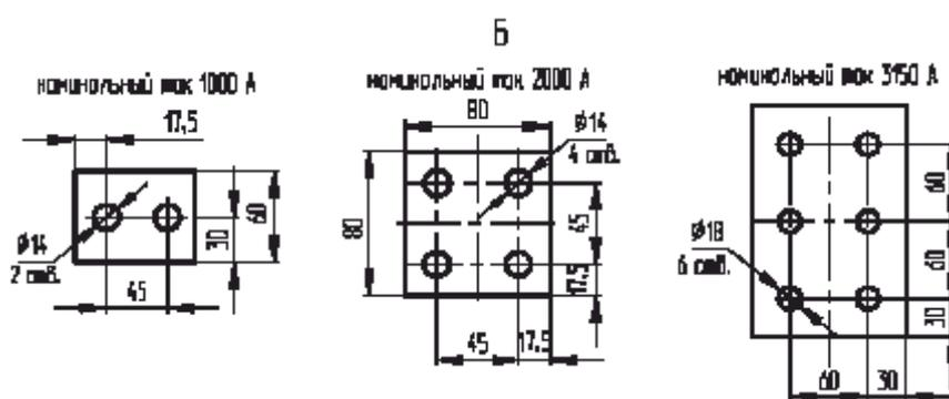
Расположение отверстий для присоединения шины заземлителя
