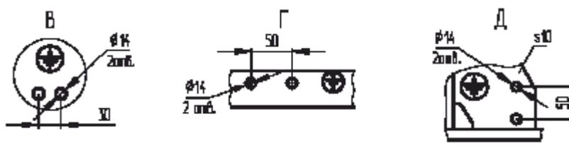
Схема установки козырьков на разъединителях РГ(Н)-220
