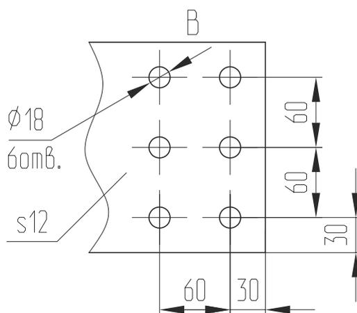
Расположение отверстий для крепления шины заземления
