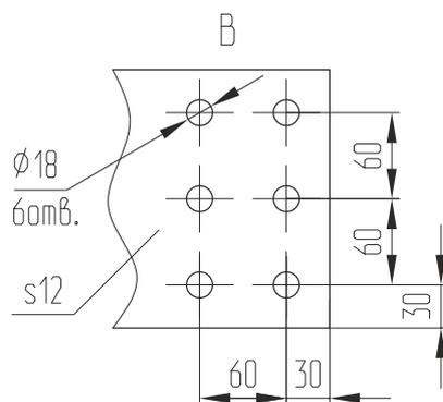
**Расположение отверстий для крепления шины заземления**
