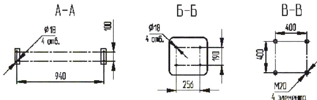
Расположение отверстий контактного вывода
