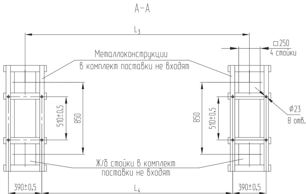
**Расположение отверстий контактного вывода**
