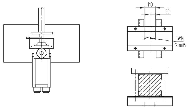
**с одним заземлителем со стороны неподвижного контакта**
