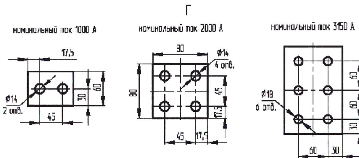
Расположение отверстий для присоединения шины заземления
