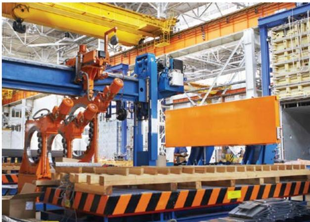
Сборка и резка электротехнической стали осуществляется с полным косым стыком по технологии STEP-LAP. При шихтовке магнитопровода используется полуавтоматическое наложение бандажей, что влияет на качество стяжки магнитопровода и обеспечивает малые значения потерь холостого хода и низкий уровень шума.
