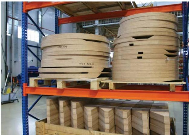
При изготовлении изоляции используется высококачественный трансформаторный картон, бук и древесно-слоистый пластик (ДПС), произведенные специализированными фирмами.
