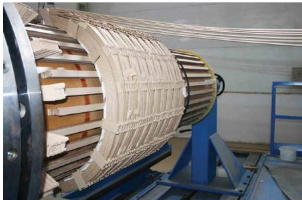
Прессовка обмоток производится в конвекционных вакуумных тоннельных печах. В процессе сушки осуществляется постоянная подпрессовка обмоток, обеспечивающая отсутствие усадки изоляции в процессе работы. Это исключает необходимость подпрессовки обмоток в дальнейшем и гарантирует надежную эксплуатацию трансформатора на протяжении всего срока службы без проведения капитального ремонта.
