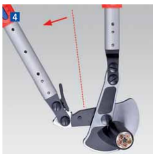
Открыть ручки по принципу трещотки после первого частичного реза.
