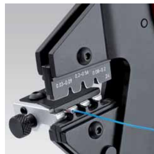
97 43 200 с матрицей опрессовочной 97 49 24 и с устройством поддержки позиционирования 97 49 93 для штекера типа D-Sub
