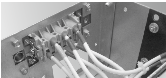
◀ Пример применения соединителя СП с установкой на панели
