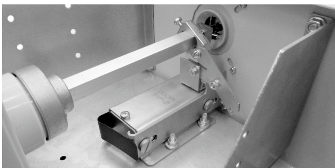
◀ Пример установки механизма привода
