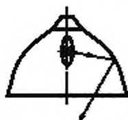
а — зеркальный отражатель, выходное отверстие открыто или с прозрачным рассеивателем
