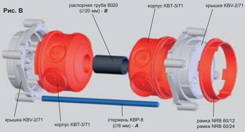
Крышка KBV-2/71 прикрепляется к неподвижной части опалубки. Корпус KBT-3/71 устанавливается в уже зафиксированную крышку KBV-2/71.
