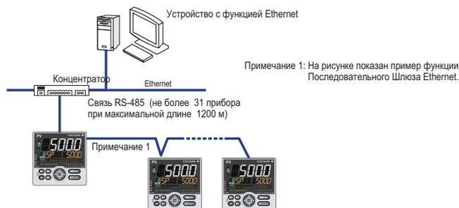
Соединение Ethernet также возможно с использованием контроллеров с функцией связи RS-485 и преобразователем Ethernet/RS-485 (рекомендуется Yokogawa VJET).
