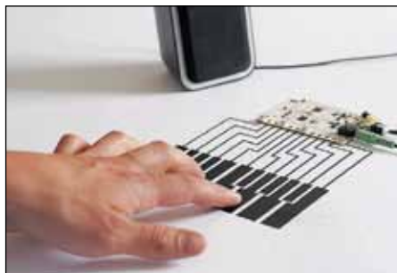
Рис. 9. Сенсорные клавиши для элементарного музыкального инструмента, нарисованные на столе при помощи Bare Conductive
