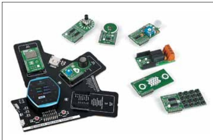
Рис. 4. Комплект для разработки носимых устройств Hexiwear с док-станцией и модулями расширения
