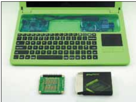
Рис. 1. Ноутбук Pi-Tor на основе Raspberry Pi и интерфейсная плата для прототипирования pi-topPROTO
