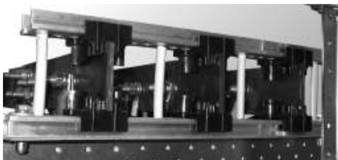
◀ Пример установки шинодержателя
