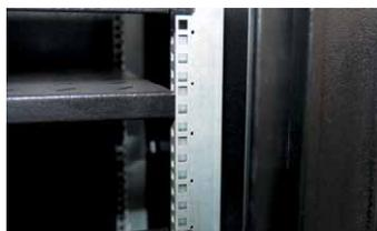
На монтажные профили нанесены метки, обозначающие высоту каждого юнита
