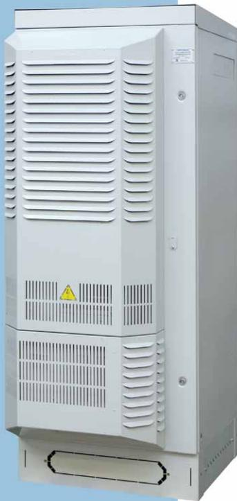
Шкаф климатический аппаратный **ST-OU-MTS-1-K** предназначен для размещения в нем 19" оборудования высотой до 20U и его автономного функционирования. Обеспечивает защиту от попадания пыли и влаги (степень защиты – IP55), антивандальную защиту и защиту от поражения электрическим током (класс 1 по ГОСТ Р МЭК 536-96 – металлический корпус).
