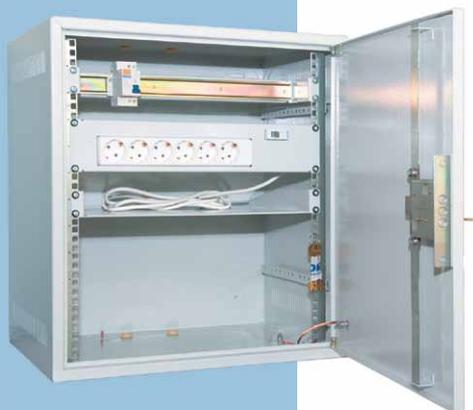
Антивандальные шкафы серии **ST2V** предназначены для защиты установленного в них сетевого, телекоммуникационного и кроссового оборудования от несанкционированного доступа. Как правило, шкафы устанавливаются в зонах без контроля доступа или с ограниченным контролем: в подъездах, на чердаках, в подвалах и других коммунальных зонах зданий.
