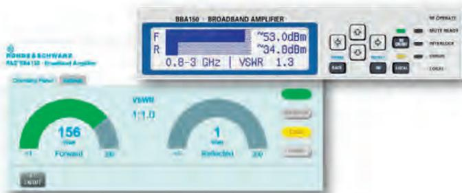
Более информативный (по сравнению с непосредственными управлением клавишами) графический web-интерфейс ноутбука или компьютера предоставляет более удобный и наглядный способ управления усилителем, а поддержка LAN и опционального GPIB интерфейсов дистанционного управления, позволит интегрировать усилитель в состав автоматизированной системы. Хорошо известные web-браузеры как то: Google Chrome, Mozilla, Firefox, Microsoft Internet Explorer – это все, что Вам нужно.
