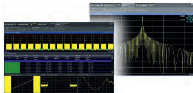
Далее I/Q-сигнал по цифровой шине передается на генератор SMW200A, который, используя аппаратный модуль замираний (опция FSW-B14) и опцию имитации целей (SMW-K78), производит изменение сигнала, внося: задержки, доплеровское смещение по частоте, изменение амплитуды из-за затухания в свободном пространстве с учётом ЭПР цели и т.д. – и переизлучает сигнал обратно в сторону РЛС через передающую антенну.
