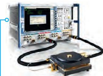
Измерение параметров пленок на основе резонатора
