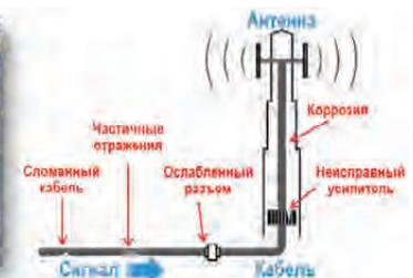
При тестировании кабелей необходимо указать модель кабеля (выбрать из уже предустановленного перечня моделей или задать вручную). Для получения наилучших и наиболее точных результатов необходимо произвести калибровку измерений. Типичная схема измерений включает: анализатор R&S®ZVH, ВЧ кабель (например, FSH-Z320/ Z321), калибровочную меру (FSH-Z28/-Z29) и объект измерений (испытываемый кабель или устройство).
