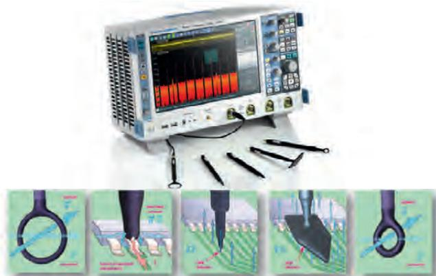
Компактный набор пробников ближнего поля R&S®HZ-15 предназначен для работы в частотном диапазоне от 30 МГц до 3 ГГц. Он также может использоваться и в диапазоне ниже 30 МГц, но со снижением чувствительности. В случае требования высокой чувствительности, опциональный предварительный усилитель R&S®HZ-16 обеспечит коэффициент усиления 20 дБ в частотном диапазоне от 100 кГц до 3 ГГц.
