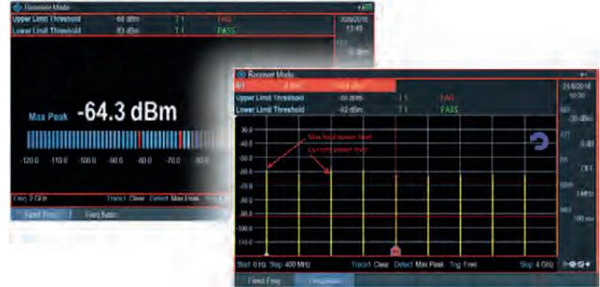
Режим измерительного приемника предназначен для предварительного тестирования на ЭМС и задач радиомониторинга. В соответствии со стандартом CISPR анализатор дооснащается соответствующими фильтрами с полосами пропускания 200 Гц, 9 кГц, 120 кГц, 1 МГц и детекторами среднего и квазипикового значений.
