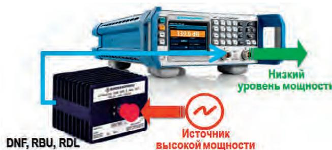
При работе с высокими уровнями мощности можно использовать каскадное соединение внешних модулей или использовать дополнительное оборудование. Вся связка будет вести себя как один аттенюатор с учетом корректирующих данных.
