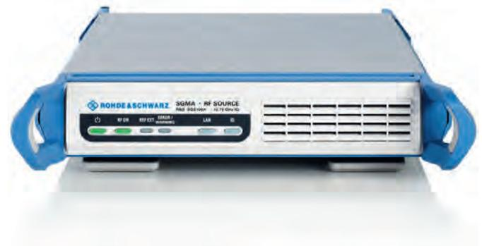
он занимает ровно половину пространства, соответственно на одной полке в 1U, при желании, можно разместить сразу два прибора (комплект для установки ZZA-KN20/21).
