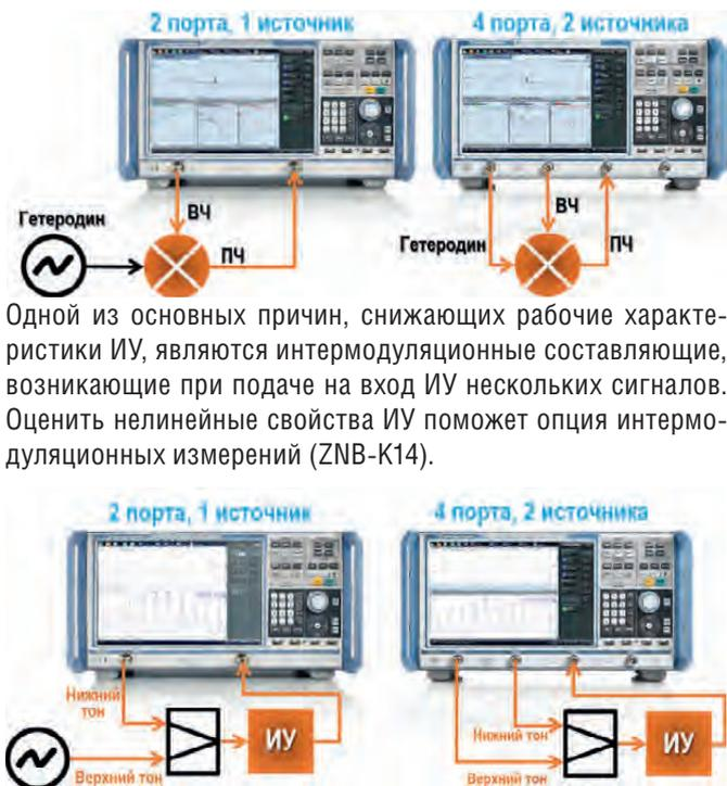
Одной из основных причин, снижающих рабочие характеристики ИУ, являются интермодуляционные составляющие, возникающие при подаче на вход нескольких сигналов. Оценить нелинейные свойства ИУ поможет опция интермодуляционных измерений (ZNB-K14).
