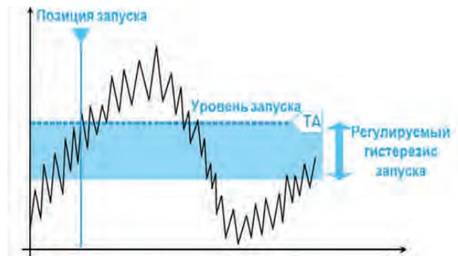
Для оптимизации чувствительности запуска предусмотрена возможность регулировки диапазона гистерезиса. Кроме того, сигналы запуска могут быть также подвергнуты дополнительной фильтрации с целью удаления ВЧ-составляющих, что предотвратит возможность запуска по причине нежелательных выбросов.
