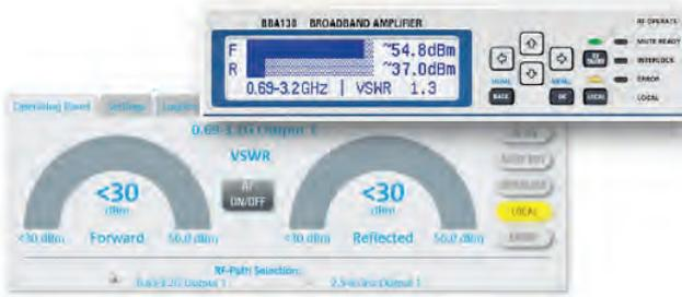
Более информативным является графический веб-интерфейс ноутбука или компьютера, а поддержка LAN и опционального GPIB интерфейсов дистанционного управления, позволит интегрировать усилитель в состав автоматизированной системы.
