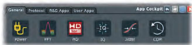
Модели R&S RTO выгодно отличаются от своих конкурентов не только большим числом автоматических измерений (более 90), но и высокой скоростью их выполнения. Они также способны создавать и отображать несколько типов осциллограмм: каналные – для каждого входного канала; опорные – для сравнения; расчетные – результат БПФ-анализа или различных вычислений (встроенный редактор формул имеет большой выбор операторов и функций).
