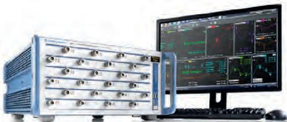
В зависимости от модели, базовый блок имеет либо 4 порта (ZNBT8), либо 8 портов (ZNBT20). Увеличить количество портов до 24 можно путём апгрейда группами по 4 порта. В отличие от решений, основанных на базе 2-х-или 4-х-портовых анализаторов с матрицами переключения, каждый порт ZNBT оснащен собственным рефлектометром, что обеспечивает максимальную производительность с точки зрения скорости измерений, выходной мощности, чувствительности и динамического диапазона, независимо от количества портов.
