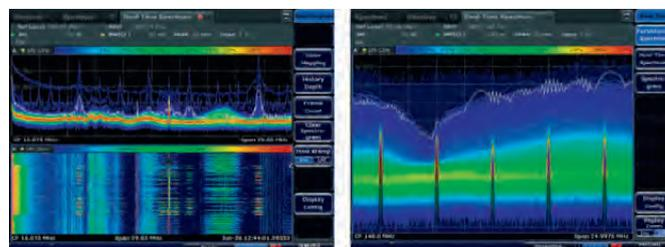
**Запуск по частотной маске** — один из способов анализа редких событий — анализатор реагирует на конкретные события в спектре. Пользователь может установить точную причину возникновения и влияние помехи.
