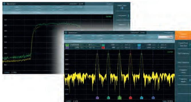
На дисплее анализатора R&S®FPC1000 можно отобразить одновременно 2 трассы и до 6 маркеров.
