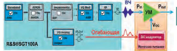
А опция SGT-K543 позволит управлять DC-модулятором уже предварительно сформированными огибающими. В данном случае используются два модулирующих генератора: 1-й обеспечивает ВЧ-сигнал на входе усилителя, 2-й обеспечивает сигналы с прямого и дифференциального I выходов для управления модулятором.
