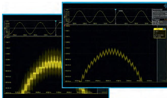
Повышение разрешения приводит к увеличению четкости отображаемой осциллограммы: становятся видны подробности сигнала, которые в противном случае были бы замаскированы шумом. Для обеспечения возможности детального анализа сигнала входная чувствительность осциллографов составляет до 500 мкВ/дел во всем частотном диапазоне.
