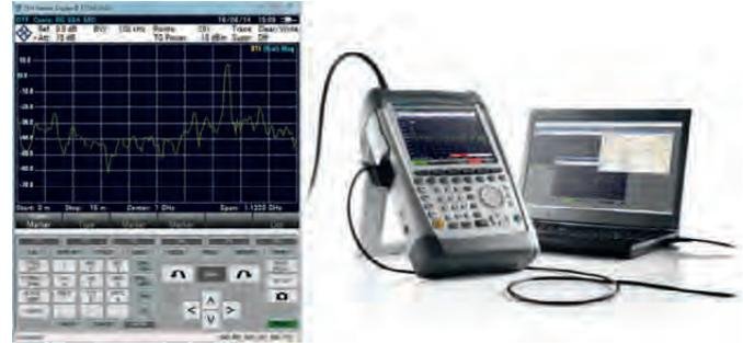
При подключении направленных датчиков FSH-Z14/Z44 возможно одновременно измерять поток мощности в обоих направлениях (прямая или падающая мощность и обратная или отраженная мощность). Зная соотношение между мощностями можно определить согласование системы. Датчики непосредственно прикручиваются к соответствующему разъему "POWER SENSOR" на верхней панели анализатора.
