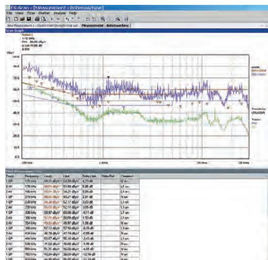
Результаты измерения напряжения помехи в диапазоне от 150 кГц до 30 МГц: обзорное измерение (графики: PK+ и AV) и окончательное измерение (графики и таблица: QP и AV) с автоматическим переключением фазы цепи стабилизации импеданса (столбец комментариев) через тестовый приемник R&S®ESPI
