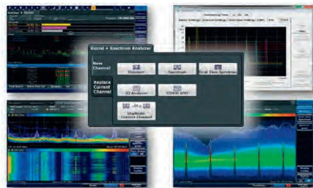
Скорость является определяющим фактором при проведении испытаний. Измерения, для которых ранее требовались минуты или даже часы, теперь выполняются буквально в считанные секунды. Исключительная скорость является следствием применения например, функции сканирования во временной области на базе БПФ, или при одновременном использовании нескольких детекторов.
