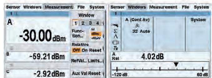
В окне могут быть выбраны различные режимы отображения результатов: Цифровое – в виде числа; Гибридное – представляет результат измерения на аналоговой шкале и также в цифровом виде; Графический режим – вычерчивает график зависимости измеренных величин от времени.
