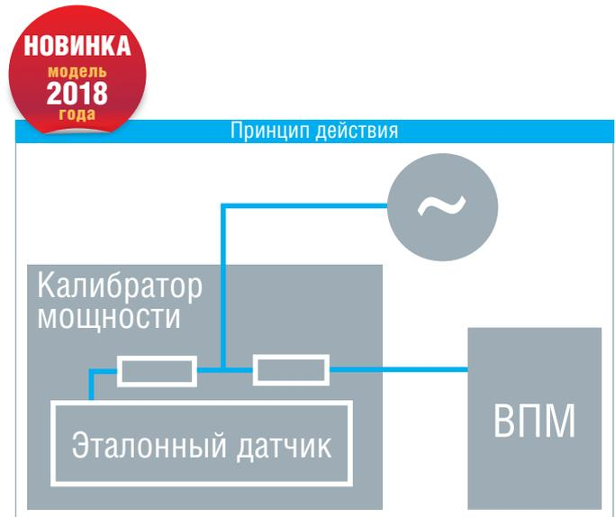
Автоматизированная система поверки измерителей мощности
