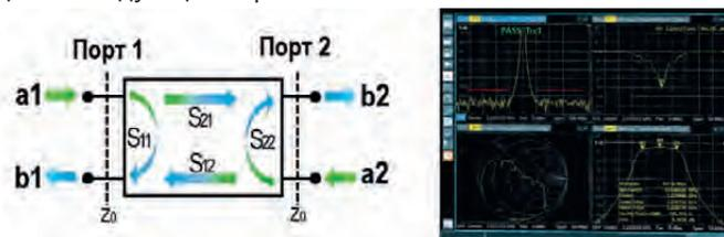
Расширить возможности анализа цепей помогут опции: анализа во временной области (ZNL-K2), для определения рассогласования в линиях передачи, отображая неоднородности,
