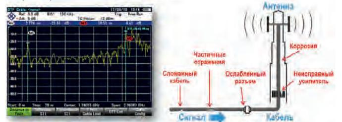
Типичная измерительная установка для тестирования кабелей и антенн включает анализатор R&S®FSH, ВЧ кабель (например, FSH-Z320/-Z321), калибровочная мера (FSH-Z28/-Z29) и испытуемый кабель.
