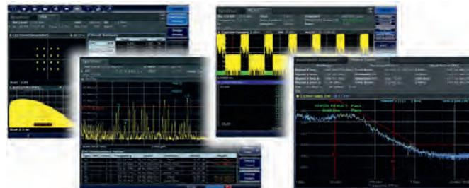
Кроме того, зачастую, приборам среднего класса, недостает программных функциональных возможностей по дополнительному автоматическому анализу сигналов. Именно поэтому линейка анализаторов спектра R&S®FSVA поддерживается внешним программным обеспечением для расширенного анализа сигналов R&S®VSE. Данное программное обеспечение дополнит приборы возможностями по автоматическому анализу импульсных сигналов, общей векторной и аналоговой демодуляции.
