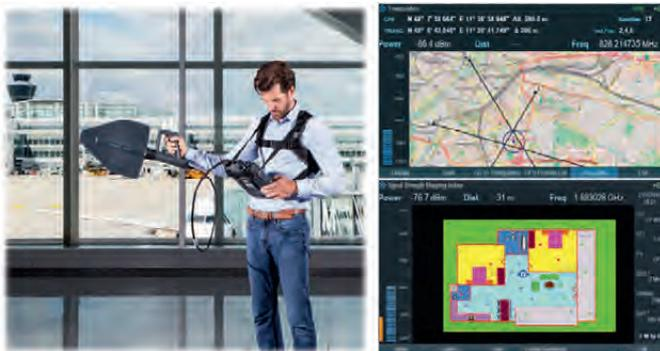
Для полноценного использования всех возможностей, доступных в режиме карт, необходима антенна и GPS-приемник (идеальным решением будет совмещенный вариант, например R&S®HE400).
