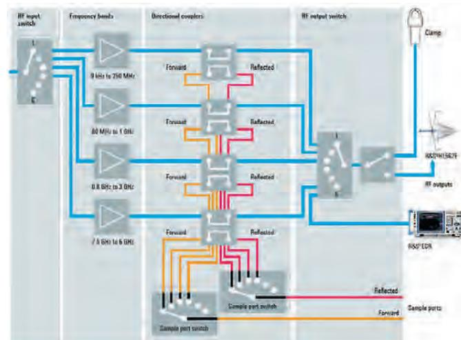
Переключатель порта сэмплинга разработан для систем с несколькими полосами частот. Он автоматически подключает соответствующий сигнал (прямой и отраженной мощности), что позволяет упростить подключение других измерительных приборов, таких как измерители мощности и анализаторы спектра, и пользователю больше не нужно отключать и затем вновь подключать измерительное оборудование при изменении полосы частот.
