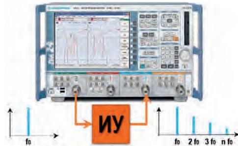
Интермодуляционные измерения также позволяют оценить нелинейные свойства ИУ. Измерения выполняются с двумя ВЧ сигналами, имеющими одинаковую мощность, но разные частоты, которые называются верхним и нижним тонами. В зависимости от конфигурации прибора, могут применяться различные схемы измерений, например, с внешним сумматором или с использованием прямого доступа (опция -B16).
