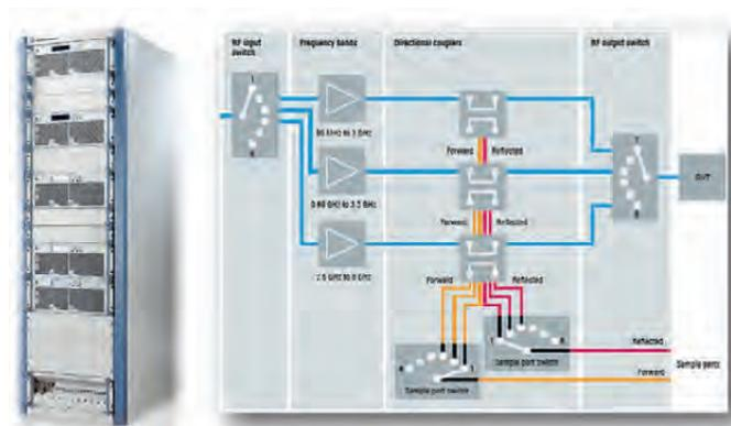
Для широкополосных усилителей серии R&S®BBA130 доступны разные варианты конструктивного исполнения: настольный вариант, или интеграция в 19-дюймовой измерительной стойке. Стойки поддерживают возможность масштабирования, что обеспечивает компактность конструкции даже в случае сложных систем.
