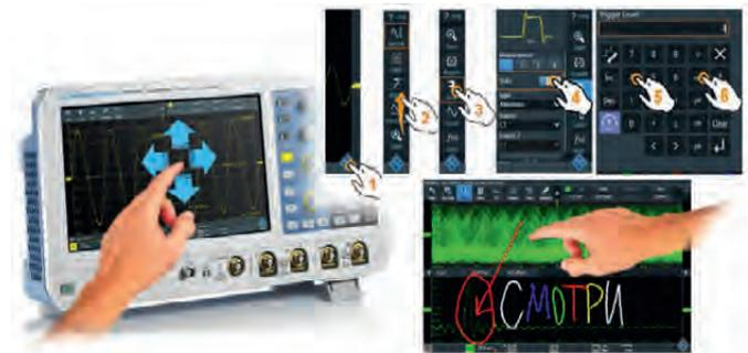
При анализе осциллограмм и, особенно, при составлении отчетов, зачастую требуется обратить внимание на определенную область, или сделать метку. В серии R&S®RTM3000 это можно сделать непосредственно на самом дисплее.
