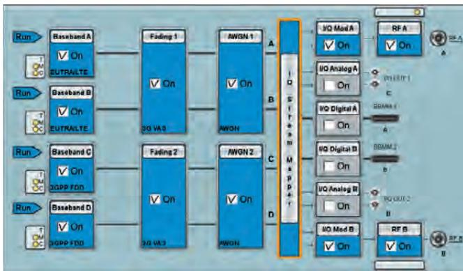
*Блок-схема генератора R&S®SMW200A, настроенного на одновременную генерацию сигнала двоянной соты стандарта HSPA и 2x2 МИМО для LTE с коррелированными каналами замираний*
