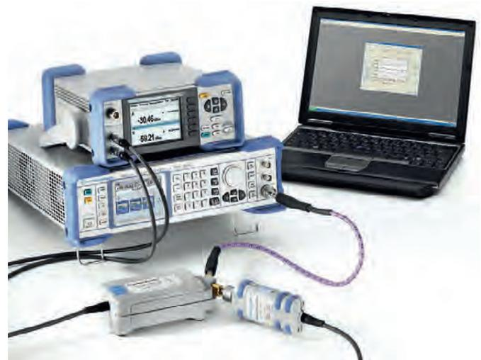
Измерительная установка для калибровки преобразователя мощности NRP-Z55
