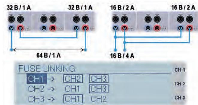
Также может быть установлена задержка срабатывания предохранителя в диапазоне от 0 до 250 мс. Тем самым, например, предотвращается срабатывание предохранителя при емкостной нагрузке.
