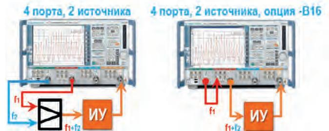
R&S®ZVA позволяет получить 2 разных типа результатов: один при измерениях с разверткой по частоте или по мощности, другой при анализе спектра интермодуляционных составляющих.
