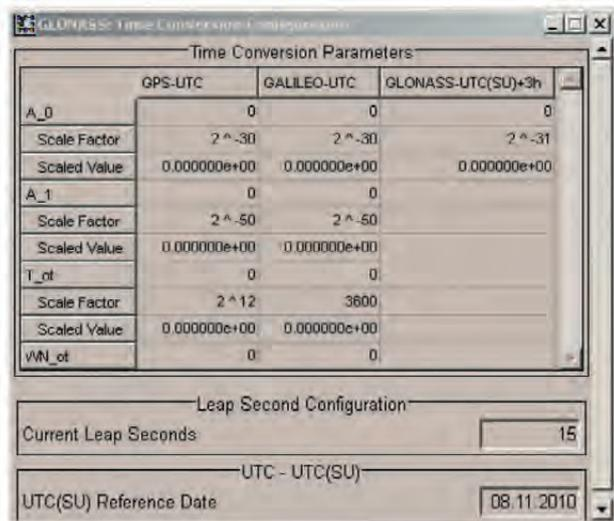
Рисунок 3. Поле ввода для настройки преобразования системного времени
