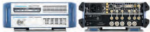
Управление генератором осуществляется при помощи приложения R&S®SGMA-GUI (входит в комплект поставки прибора), устанавливаемого на внешнем ПК. Данное ПО может управлять сразу 12 приборами через различные комбинации интерфейсов LAN, USB, PCIe.
