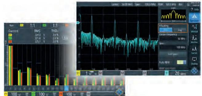
Опция RTH-K34 добавляет возможность анализа гармоник, включая функцию измерения гармонических искажений. Автоматически измеряется уровень, фаза и частота каждой гармоники.
