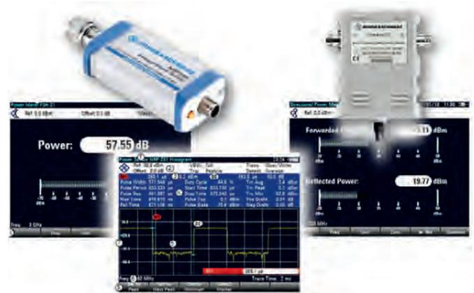
Опция R&S®FSH-K29 в сочетании с широкополосными датчиками мощности семейства NRP-Z8x позволит проводить анализ мощности импульсных сигналов. Основные параметры импульса, такие как длительность, время нарастания/спада, коэффициент заполнения и т.д. отображаются автоматически. Также можно воспользоваться функцией запуска и маркерами и выполнить масштабирование отображения импульсов.
