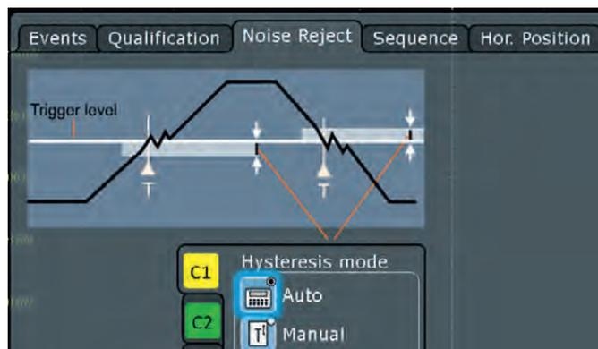
Сигналы запуска могут быть также подвергнуты дополнительной фильтрации с целью удаления ВЧ-составляющих, что предотвратит возможность запуска по причине нежелательных выбросов.
