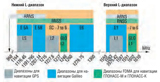
Рисунок 4. Диапазоны частот ГСС для ГЛОНАСС, GPS и Galileo
