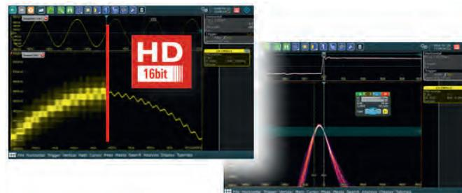
Повышение разрешения приводит к увеличению четкости отображаемой осциллограммы – становятся видны такие подробности сигнала, которые в противном случае были бы замаскированы шумом. Кроме того, в этом режиме увеличивается чувствительность с 1 мВ/дел. до 500 мкВ/дел., благодаря чему становится возможным запуск по самым незначительным выбросам сигнала.
