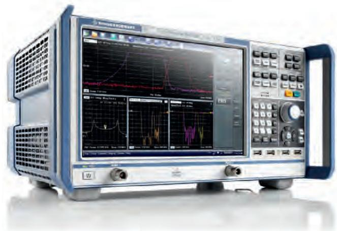
Дополнить возможности прибора можно только двумя опциями: расширив диапазон мощности (опция ZNC-B22), уменьшив минимальный уровень источника до -50 дБм, или добавив возможность анализа во временной области (опция ZNC-K2), позволяющий более четко выявлять характеристики ИУ, например, таких как кабели и фильтры.
