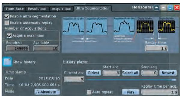
В свою очередь, высокая скорость отображения сигналов (в данном режиме до 1,5 млн осциллограмм/с) дает возможность исследовать едва различимые детали сигнала, такие как шум или джиттер, и что ещё более важно, не позволяя пропустить случайные и редкие события.
