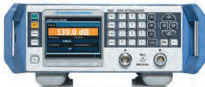
встроенного резистивного модуля с возможностью управления только внешними модулями ослабления (до 4-х). Модули отличаются частотным диапазоном и шагом ослабления. Два ВЧ-порта — "А" и "В" (вход / выход) для встроенных в блок резистивных секций, могут размещаться на задней панели.
