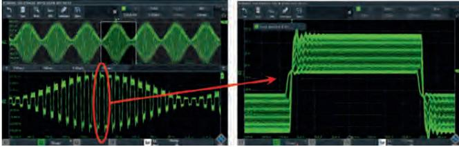
Еще больше оптимизировать сбор данных поможет сегментированная память. В данном режиме осуществляется выборочное сохранение важных участков сигналов, пропускающая несущественные фрагменты, когда сигнал отсутствует или не меняется, например, при анализе пачек радиолокационных импульсов, следующих с большой скважностью, или пакетных сигналов последовательных шин. В моделях R&S®RTA4000 можно настроить до 87'380 сегментов, а общий объем памяти может достигать 1 млрд. точек.
