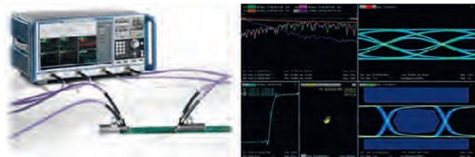
Опция ZNB-K4 (измерения с преобразованием частоты) позволяет задавать смещение между частотами источника и приёмника, что дает возможность измерять гармонические составляющие на выходе ИУ, а также измерять характеристики амплитуды, фазы и ГВЗ устройств с преобразованием частоты, например, смесителей.
