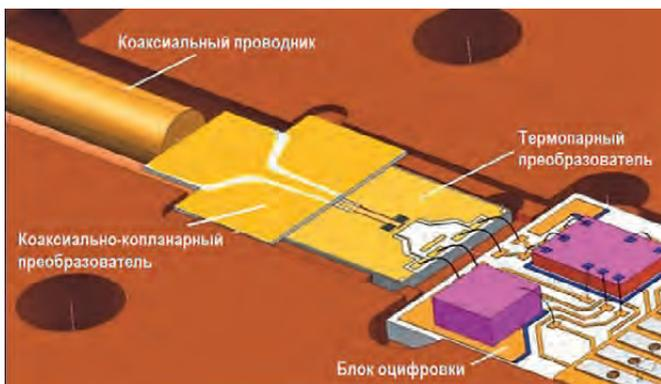
Входной каскад ВЧ-тракта с коаксиально-копланарным преобразователем
