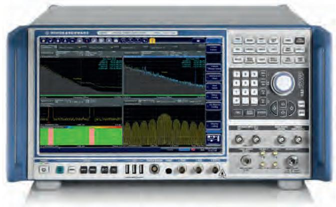
лит проводить кросскорреляционную обработку. А малошумящие источники постоянного тока значительно упрощают измерение параметров ГУН.
