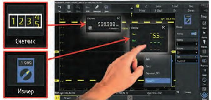
Вольтметр имеет разрядность 3 знака. Доступны измерения: DC/ AC+DC RMS/ AC RMS (для различных каналов), а 6-разрядный частотомер одновременно отображает частотные и временные параметры.
