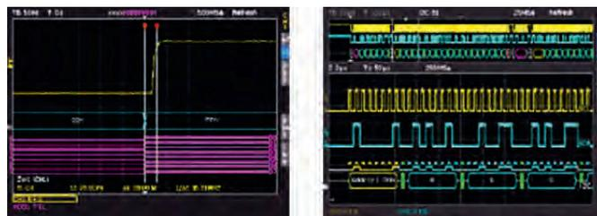
Универсальные опции RTC-K1,-K2,-K3 обеспечивают синхронизацию и декодирование протоколов последовательных интерфейсов I2C, SPI, UART/RS-232/-422/-485, CAN/LIN. Имеется возможность селективного захвата данных и анализа соответствующих событий и данных.
