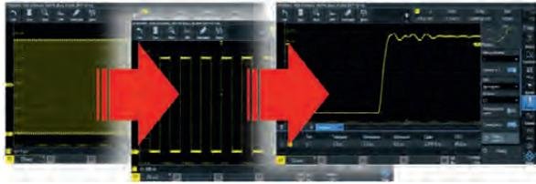
Сократить время простоя при сборе данных поможет опция RTM-K15 (режим истории и сегментированной памяти). В этом режиме осуществляется деление доступной памяти на более мелкие сегменты, и записывается в них не весь сигнал, а только его часть, подходящая под определенные требования (условия запуска). Пользователь может выбрать не только размер и количество сегментов, но и задать скорость их воспроизведения.
