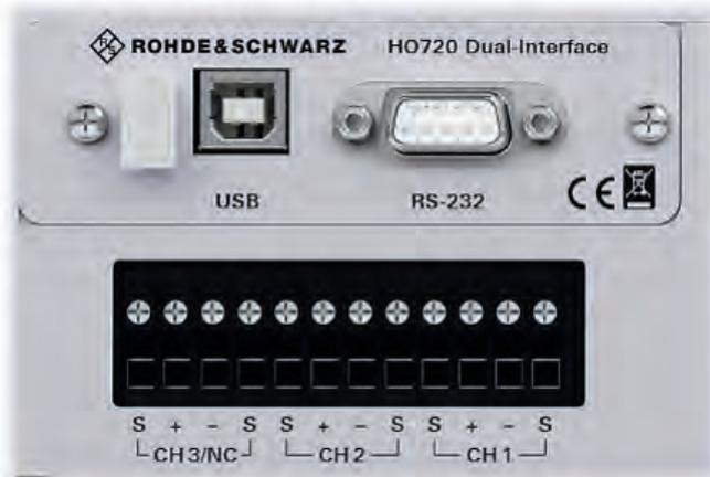
В стандартной комплектации приборы оснащены интерфейсами RS-232/USB (опция H0720). Дополнительно в приборы можно установить интерфейсные платы Ethernet/USB (опция H0730) или IEEE 488 (GPIB) (опция H0740). Дистанционное управление обеспечивает доступ практически ко всем функциям, имеющимся на передней панели. Для программирования приборов используются стандартные SCPI-команды.
