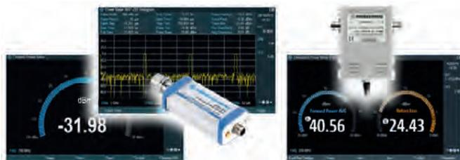
С направленными датчиками FSH-Z14/Z44 возможно одновременно измерять поток мощности в обоих направлениях (прямая или падающая мощность и обратная или отраженная мощность). Соотношение мощностей позволит определять согласование системы. Для подключения датчиков необходим адаптер FSH-Z144.
