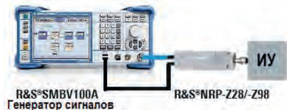
Для измерения мощности не нужно отключать ИУ от источника ВЧ сигнала. Кроме того, это обеспечивает оптимальное согласование сопротивления с ИУ. Исключаются также дополнительные погрешности, вызванные, например, потерями в кабеле между генератором и ИУ. Кроме чистых измерений мощности, датчики позволяют автоматически корректировать уровень.
