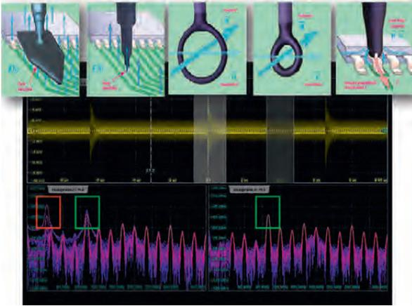
Набор возможно использовать и в диапазоне ниже 30 МГц, но со снижением чувствительности. Избежать этого эффекта поможет предварительный усилитель R&S®HZ-16 с коэффициент усиления 20 дБ в частотном диапазоне от 100 кГц.
