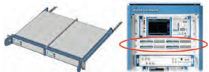
С целью обеспечения малых размеров прибор не оснащен экраном, но на передней панели имеется достаточное количество индикаторов, информирующих о состоянии прибора. Все разъемы и интерфейсы управления расположены на задней панели.
