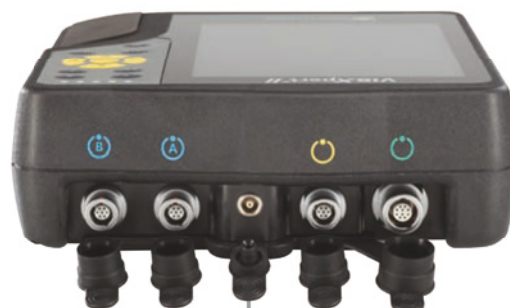
Измерительные каналы A и B Гнездо для зарядного устройства Температура USB/Ethernet Триггер/датчик оборотов Последовательный порт (RS 232) Аналоговый выход
