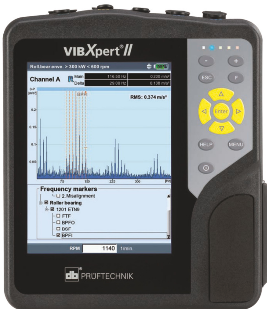
Спектр огибающей подшипника качения с дефектом внутреннего кольца, наличие боковых частот.
