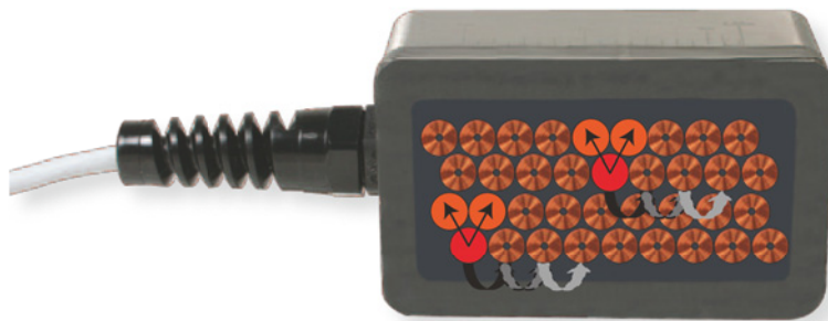
Принцип мультиплексирования элементов. Катушки показаны только для иллюстрации.
