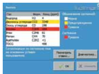
Встроенное диагностическое ПО позволяет провести анализ и диагностику несколькими прикосновениями к экрану
