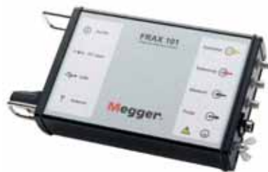
Для работы с FRAX101 необходим ПК. Связь с прибором может осуществляться через USB или промышленный Bluetooth (до 100 м)
