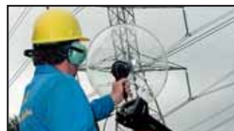
Обследование высоковольтных изоляторов
