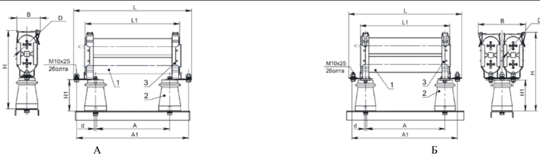
Рисунок 2. Габаритные и установочные размеры предохранителей ПКТ-103, ПКТ-104.
