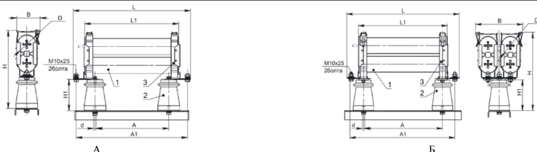
Рисунок 2. Габаритные и установочные размеры предохранителей ПКТ-103, ПКТ-104.
