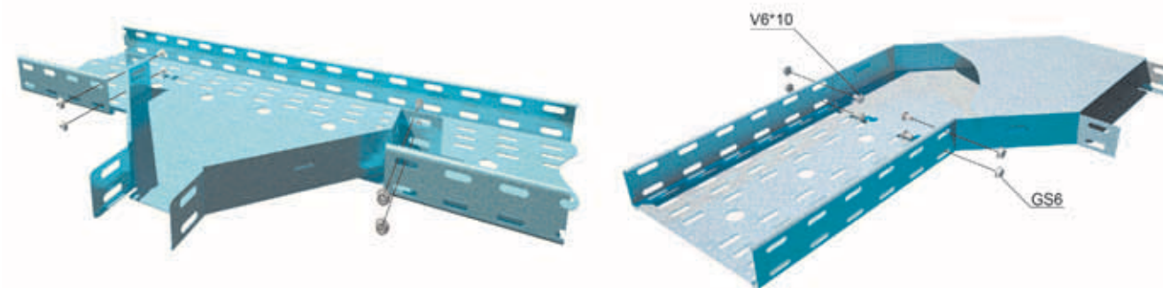
Схемы монтажа аксессуаров для разветвления кабельной трассы
