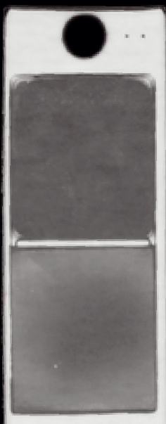
Рисунок 4. Ультразвуковое сканирование паяного шва модуля MIFA
