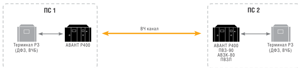
Рисунок 1. Канал связи для высокочастотных защит «точка-точка»
