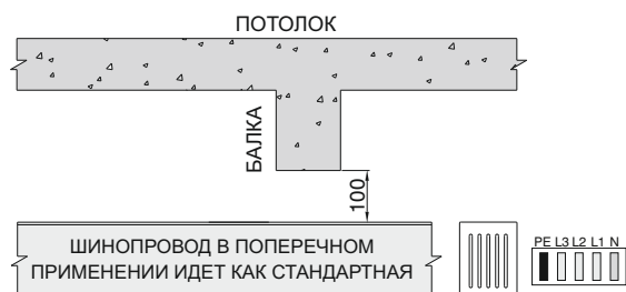
РИСУНОК 4 - ПЕРЕСЕЧЕНИЕ ПОД БАЛКОЙ А В ПОПЕРЕЧНОМ ПРИМЕНЕНИИ
