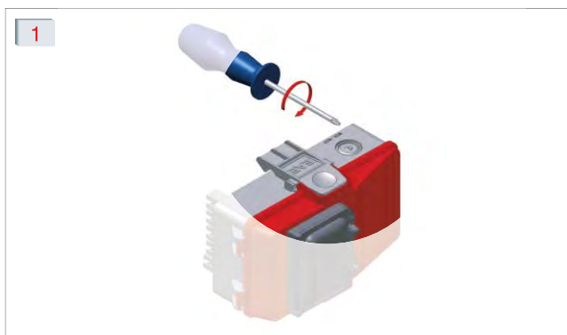
Открутите крепежные болты крышки
