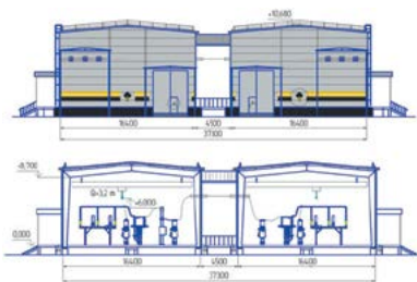
Закрытое распределительное устройство ЗРУ-СЭЩ 110 кВ
