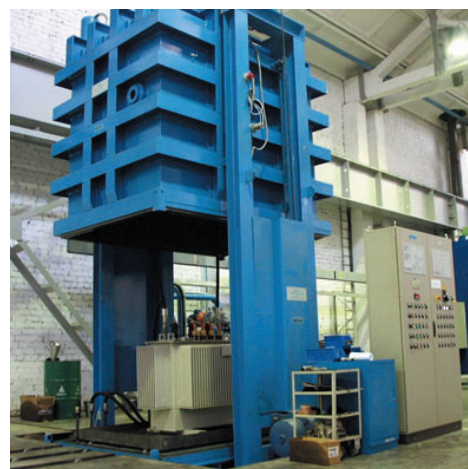
Участок заливки масла в ТМПНГ
