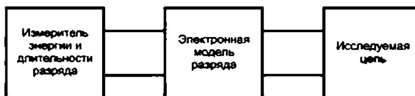
Рисунок А.26 — Блок-схема установки для электронизмерительной оценки параметров разряда
