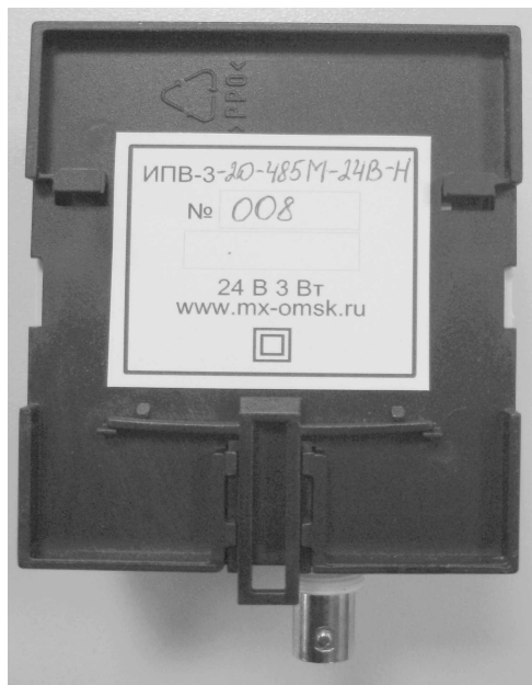
Рисунок 12. Маркировка на нижней поверхности корпуса
