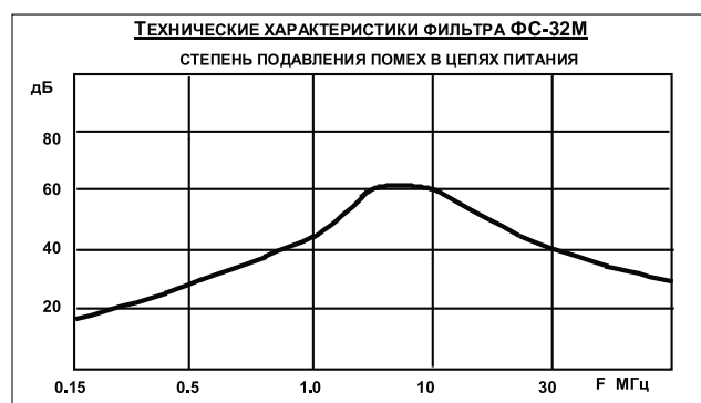
График АЧХ фильтра ФС-32М
