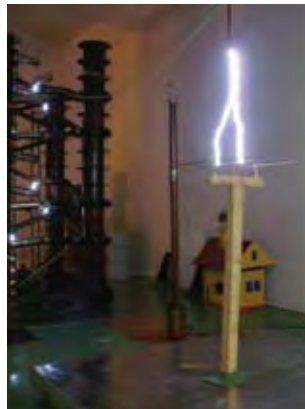
Имитирование атмосферных разрядов в модель воздушной линии в Лаборатории высоких напряжений Galmar
