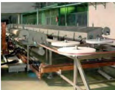
Гальваническая линия для изготовления омедненных проводников с толщиной покрытия более 0.070 мм
