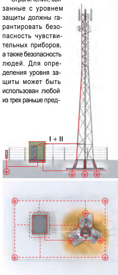
Рис. 13 Молниезащитная система металлических GSM башен
