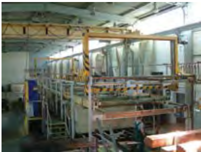
Линия для изготовления заземлителей омедненных слоем толщиной Cu не менее 0.250 мм
