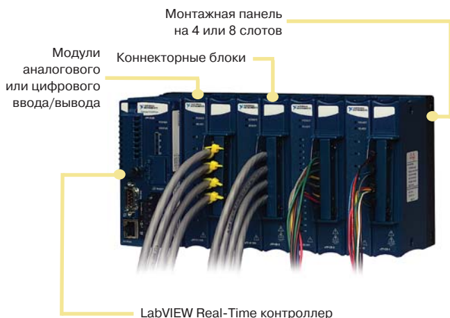
Рис. 1. Compact FieldPoint сочетает надежность программируемых логических контроллеров с функциональностью ПК.
