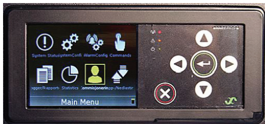
Рис.4 Внешний вид лицевой панели блока Master контроллера Smartpack2
