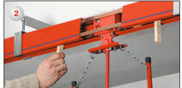
2 Снимите корпус из ПВХ, как показано на рисунке.
