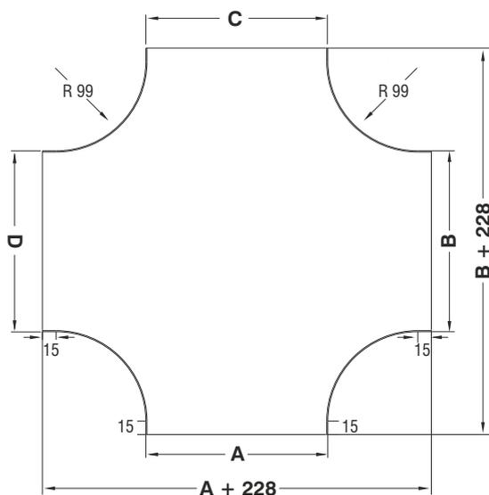
►► КРЫШКА ВЕРТИКАЛЬНОЙ ВНУТРЕННЕЙ ПОВОРОТНОЙ СЕКЦИИ СЕРИИ UKFG-C
