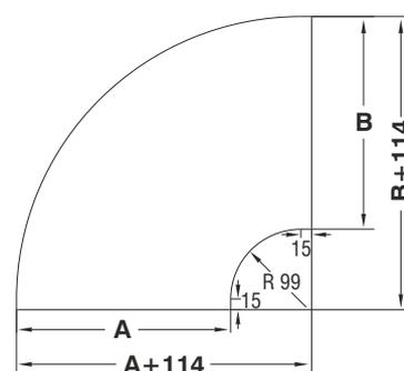
►► КРЫШКА Т-ОБРАЗНОЙ ГОРИЗОНТАЛЬНОЙ ПОВОРОТНОЙ СЕКЦИИ СЕРИИ UKFG-C
