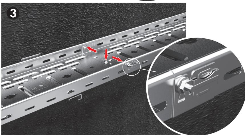
Следует использовать болты заземления.
