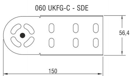
Вертикальный шарнирный элемент для смены уровня в количестве 4 штуки, Болт М6х12 4 штуки, Гайка М6 4 штуки.
