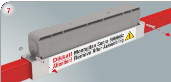
7-) Снимите болты пластины выравнивающей планки, находящейся на компенсационной секции.
