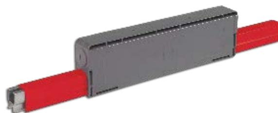
Секция компенсационная - защищающая систему от механических напряжений вызванных температурными колебаниями - устанавливается через каждые 100 метров трассы и на осадочных швах зданий, сооружений.
