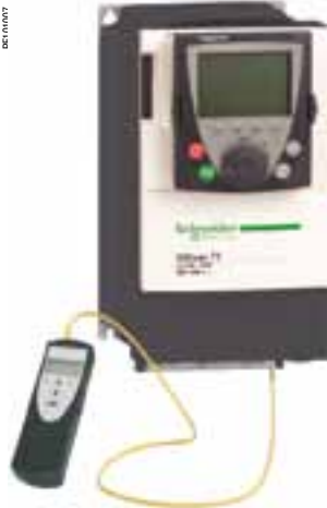
Конфигурирование ПЧ Altivar 71 с помощью мультизагрузчика
