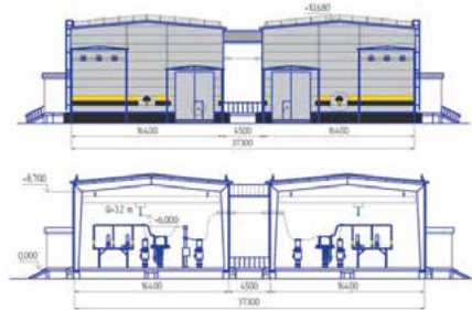
Закрытое распределительное устройство ЗРУ-СЭЩ 110 кВ
