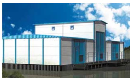
Закрытая подстанция 35/20 (10-6) кВ
