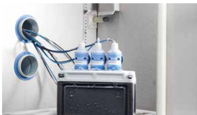
Produktprüfung bei -25°C
