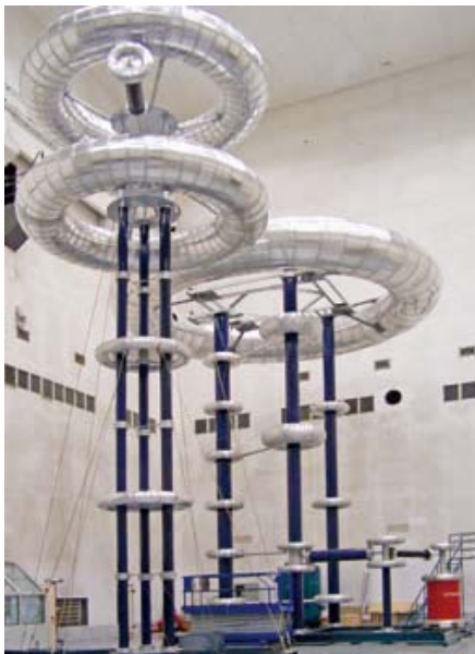
Установка для испытания диэлектрической прочности изоляции постоянного тока 1200 кВ/30 мА
