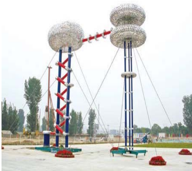
Установка для испытания диэлектрической прочности изоляции постоянного тока 1500 кВ/40 мА
